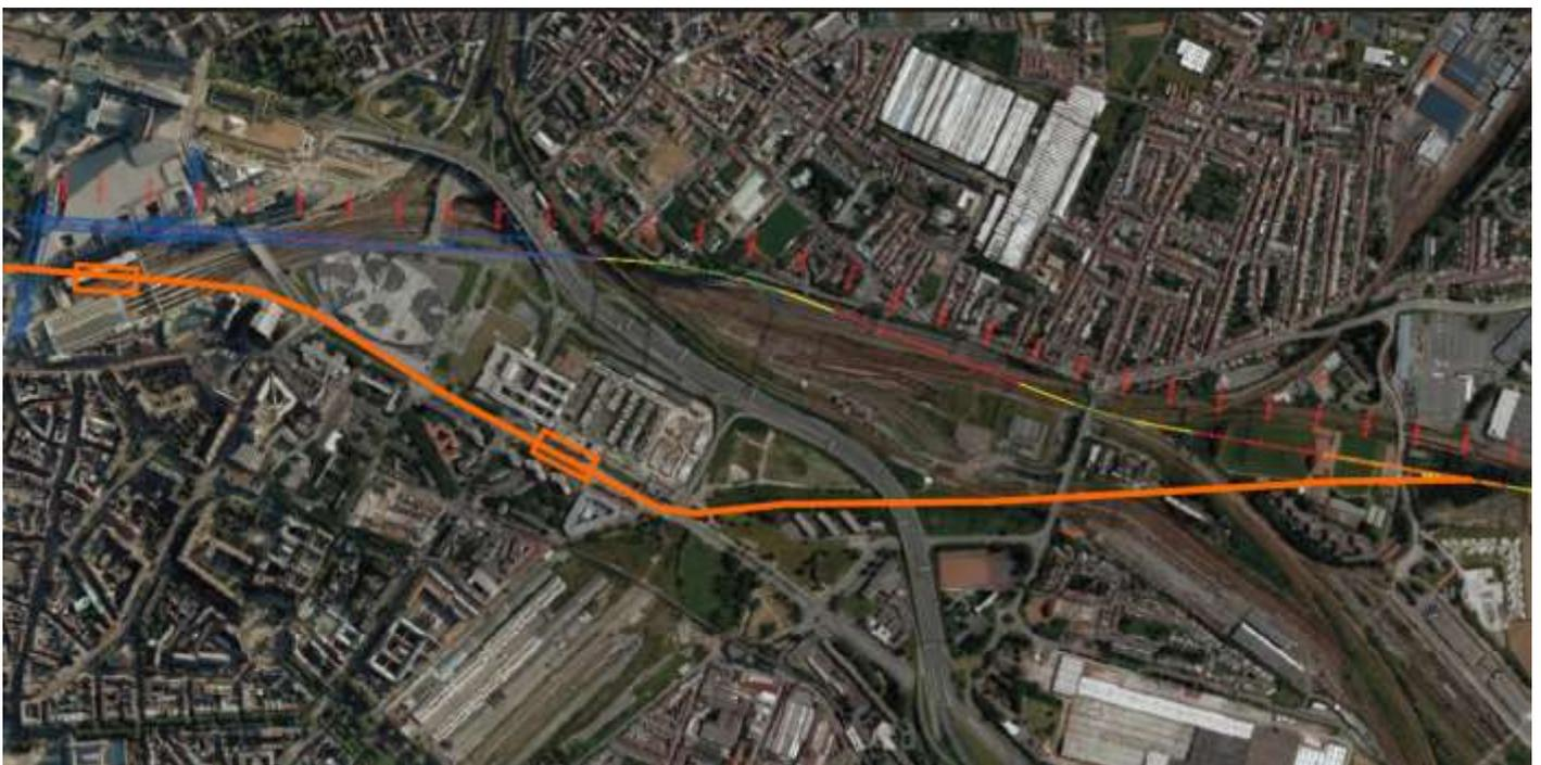
Fig.4 : comparatif des tracés sur l'avant-gare Lille Flandres et implantation de la nouvelle gare Lille Grand palais
