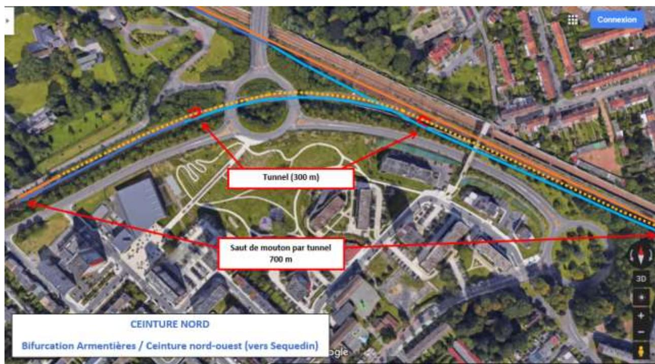
Fig.11 : Schéma indicatif d'un saut de mouton par terrier au triangle de St André (REM) pour rejoindre la boucle ouest
